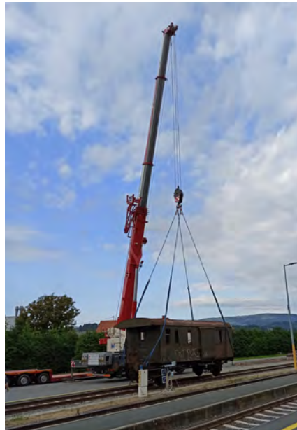
Wagon Pwi 133 - Per Kran auf den Tieflader
