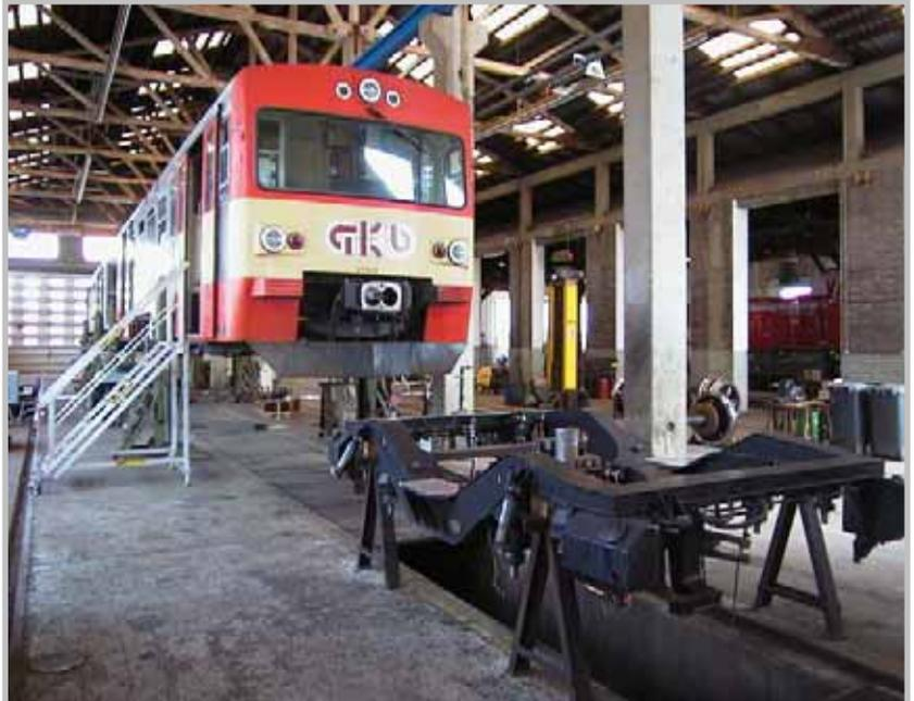
Triebwagen VT70.02 in angehobenem Zustand in der Umbauphase mit zerlegtem Drehgestell im Vordergrund.
