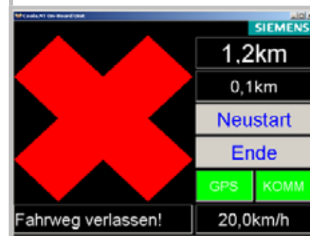
Foto oben: Bildschirm der OBU im Tfz mit Anzeige des freigegebenen Streckenabschnitts und div. Zusatzinformationen
