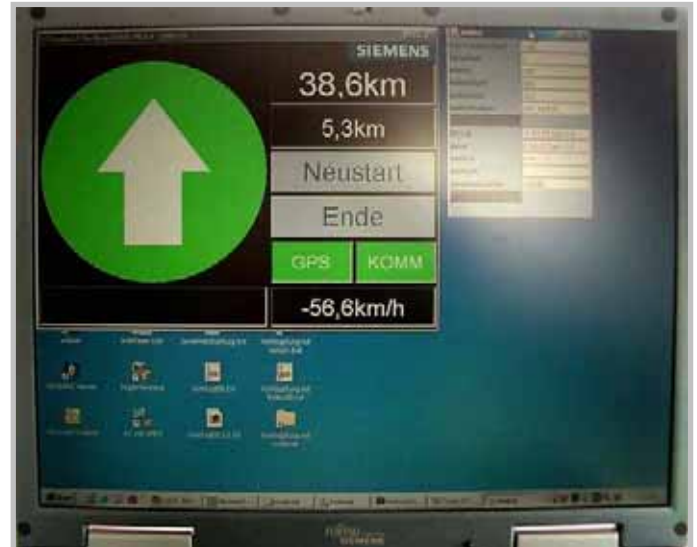
Foto oben: Bildschirm der OBU im Tfz mit Anzeige des freigegebenen Streckenabschnitts und div. Zusatzinformationen
