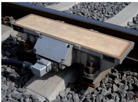
PZB-Gleismagnet mit 2000 Hz am Bf. Lieboch
