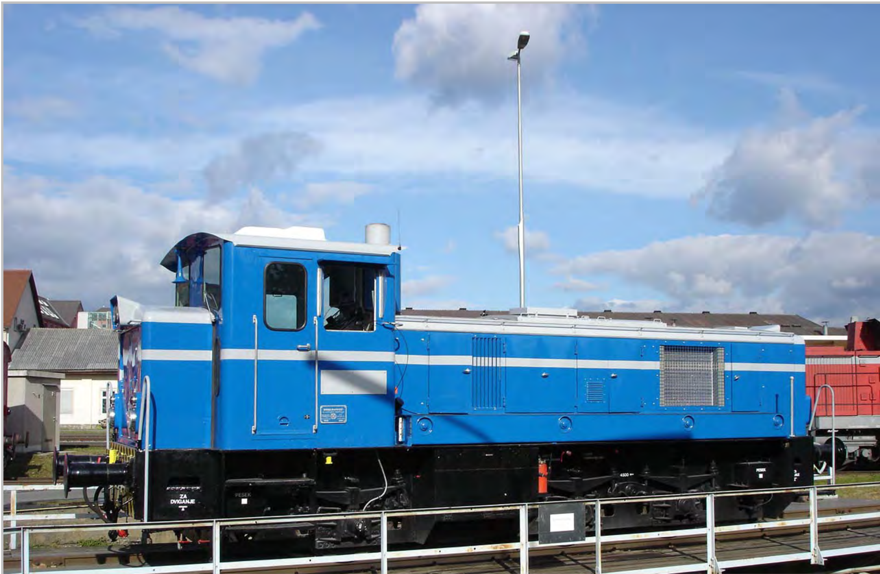
Remotorisierte und modernisierte Lok DHL600H der Fa. Salonit Anhovo am Graz Köflacherbahnhof © Thomas Ottschoffski, EB-IH-EN (31. 10. 2007)
