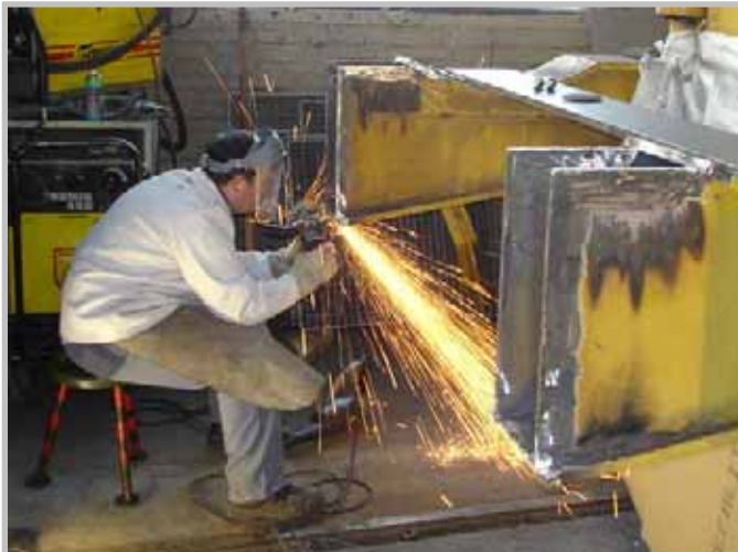
Foto oben: Thomas Scherz bei der Schweißstoßvorbereitung nach Auslösen der beschädigten Pufferbrust der Gleisbaumaschine
